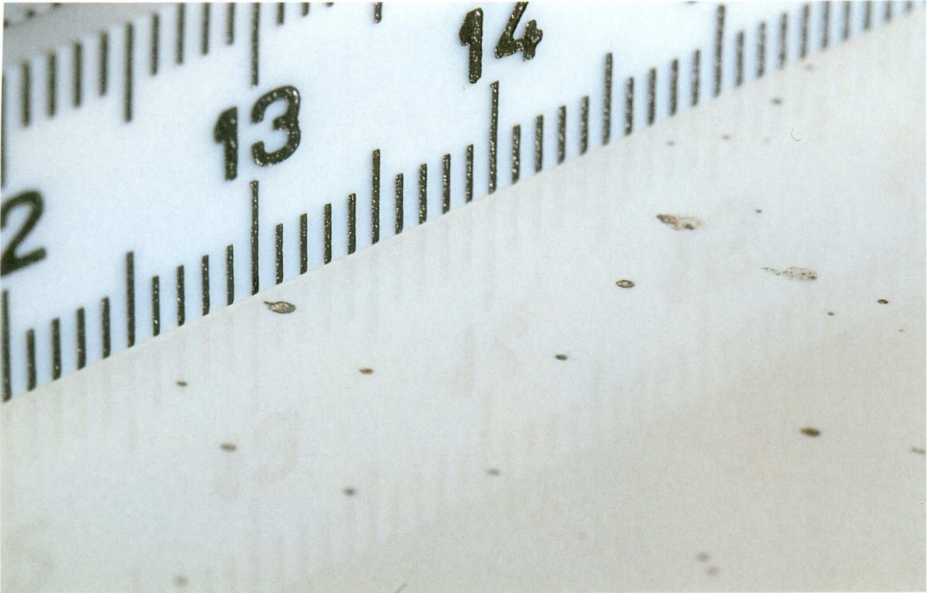
Fig. 1 Plaque en céramique endommagée par des étincelles
