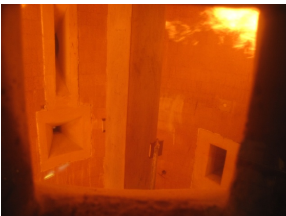
Figure 4 Essai au feu d'une colonne chargée, durant lequel aucun écaillage ne s'est produit après 150 minutes (BAM Berlin)
