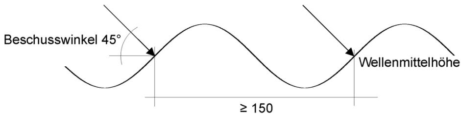
Abbildung 6 Beschussort und Beschusswinkel bei der profilierten Kunststoffplatte (hier am Beispiel der gewellten Kunststoffplatte) als Fassadenbauteil mit horizontaler oder diagonaler Profilrichtung im Seitenriss (Masse in Millimeter)
