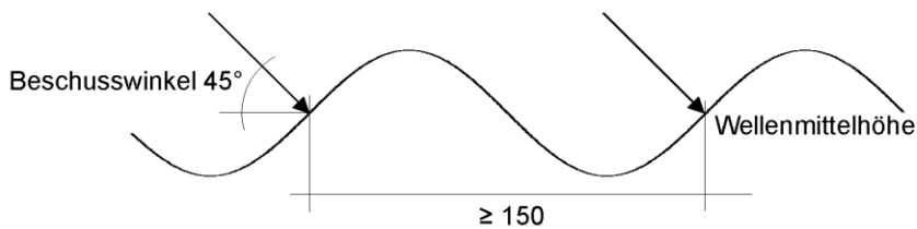
Abbildung 3 Besussorte und Besusswinkel der profilierten Bitumenplatte als Fassadenbauteil bei horizontaler oder diagonaler Ausrichtung des Profils hier am Beispiel der gewellten Bitumenplatte (Masse in Millimeter)
