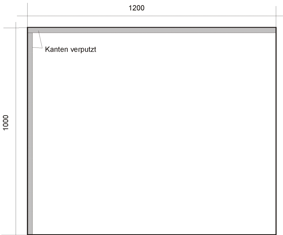
Abbildung 1 Versuchsaufbau Putz auf festem Untergrund (Masse in Millimeter)
